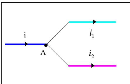
Illustrazione del primo principio di Kirchhoff (o legge dei nodi o legge delle correnti). Poiché non si può creare né accumulare carica elettrica nel punto A, la corrente  $i$  che entra nel punto A deve essere uguale alla somma  $i_1 + i_2$  delle correnti che ne escono
